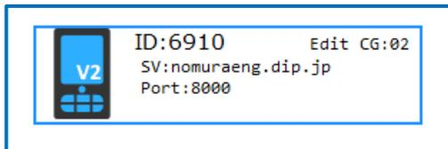
正常に接続されると ID が表示されます。SRPC-MBL の筐体に貼ってある識別ラベルに印字されている ID と画面上の ID が一致していることを確認して下さい。
