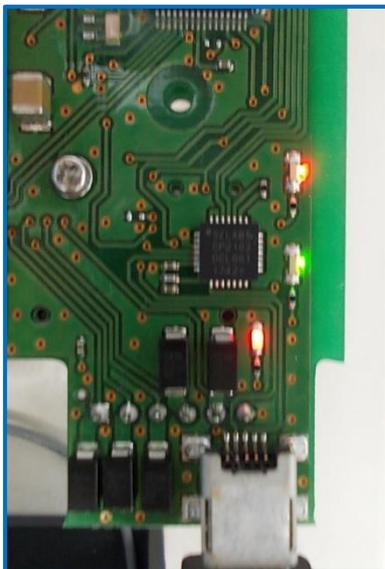
電源を投入すると、緑 LED が点灯し、赤 LED が点滅し始めます。赤 LED が5秒に1回の点滅に変化するまで待っててください。
