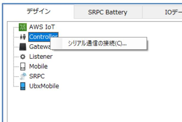
シリアルボードが PC に USB 接続されているので「Controller」を右クリックします。
