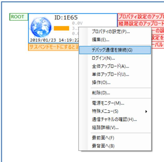
SRPC-MBL のアイコンを右クリックします。“デバッグ通信を接続”を選択します。
